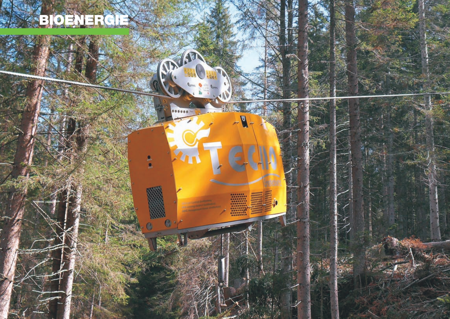
Il carrello autotraslante Tecno-SLOPE consente un elevatissimo grado di automazione e sicurezza sul lavoro The Tecno-SLOPE crane mobile yarder ensures great automation and safety at work
