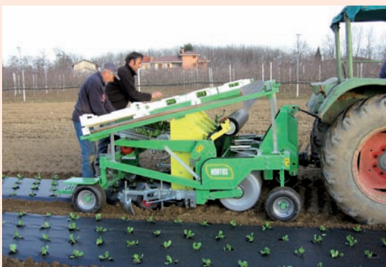
Le trapiantatrici possono essere equipaggiate del modulo per la stesura del telo pacciamante, che può essere anche di materiale biodegradabile
