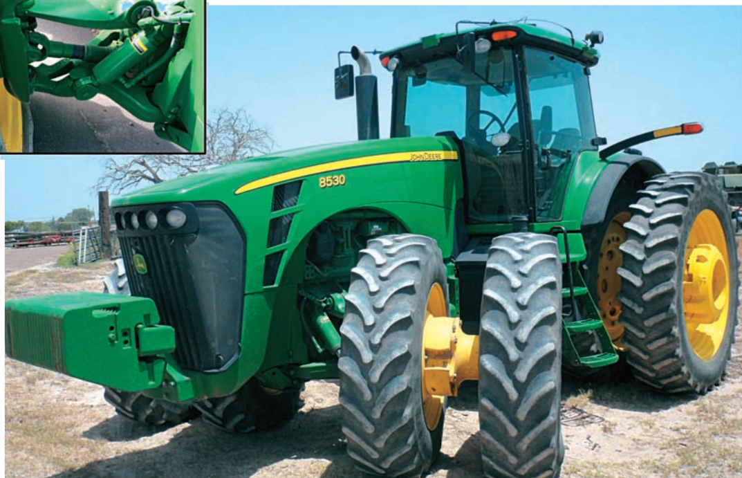
La sospensione anteriore a ruote indipendenti ILS di John Deere John Deere's ILS front independent suspension
