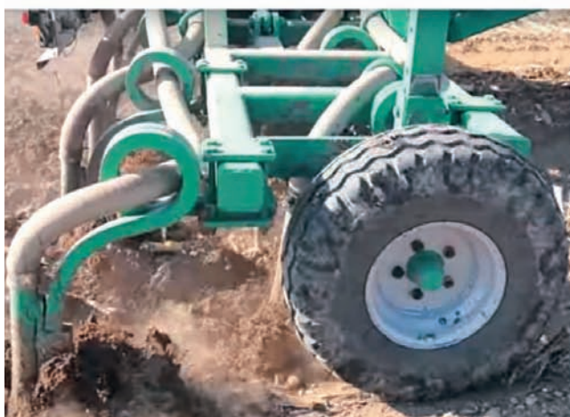
L'interramento, superficiale o profondo, dei liquami è realizzato tramite organi di lavorazione del terreno fissi o rotanti. A sinistra alcune soluzioni di Bossini, a destra di Vendrame Superficial or deep burying of slurry is performed with fixed or rotating components. On the left are some solutions produced by Bossini and on the right by Vendrame on the left
