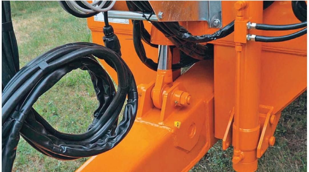
Il timone idraulico di Vaia permette di variare facilmente in continuo l'altezza dell'occhione The Vaia hydraulic drawbar enables ongoing variation of the eye hook
