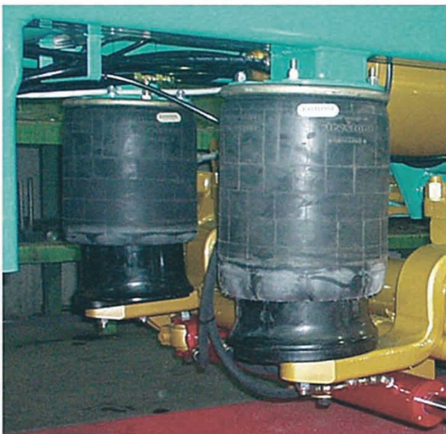
A sinistra: timone e ruote sterzanti di Vendrame; a destra: in alto, le sospensioni idrauliche di Zaccaria e, in basso, quelle pneumatiche di Al.Pa.Car Pagliari Drawbar and steering wheels by Vendrame on the left; above right hydraulic suspension by Zaccaria and, below, pneumatic suspension by Al.Pa.Car Pagliari
