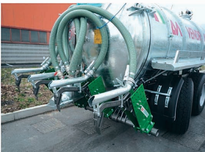
L'interramento, superficiale o profondo, dei liquami è realizzato tramite organi di lavorazione del terreno fissi o rotanti. A sinistra alcune soluzioni di Bossini, a destra di Vendrame Superficial or deep burying of slurry is performed with fixed or rotating components. On the left are some solutions produced by Bossini and on the right by Vendrame on the left
