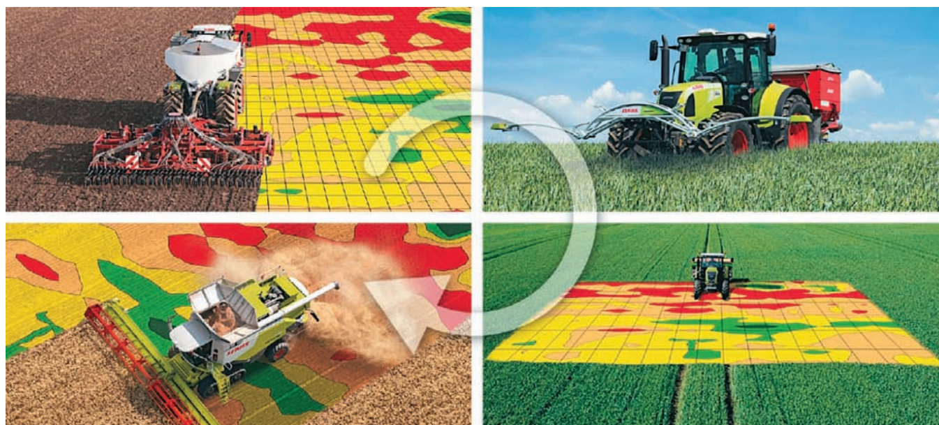
Fig. 3 - Nell'ordine: semina a densità variabile, concimazione VRT e mappatura finale del raccolto (http://www.thedroneinfo.com) Fig. 3 - In the order: variable density sowing, VRT fertilization and final crop mapping (http://www.thedroneinfo.com)
