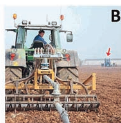
A partire dalla creazione di una rete sotterranea di distribuzione (A), i sistemi ombelicali prevedono l'aggiunta del liquame tramite un rotolone (B) e una tubazione flessibile (C) all'attrezzatura deputata all'interramento (D) Beginning with lay an underground hose network (A), the umbilical system can convey slurry via hose reels (B) and flexible hose (C) to the depths for burying (D)
