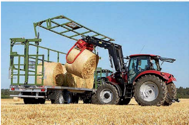
Per il contenimento delle balle, i carri sono dotati di robuste strutture tubolari anteriori e posteriori (sopra), e talvolta anche sui lati lunghi e superiormente, in qualche caso movimentate tramite cilindri idraulici (al centro e sotto) For bale containment, the wagons have sturdy front and rear tubular structures (above), and sometimes also on the long sides and top, in some cases moved by hydraulic cylinders (centre and bottom)
