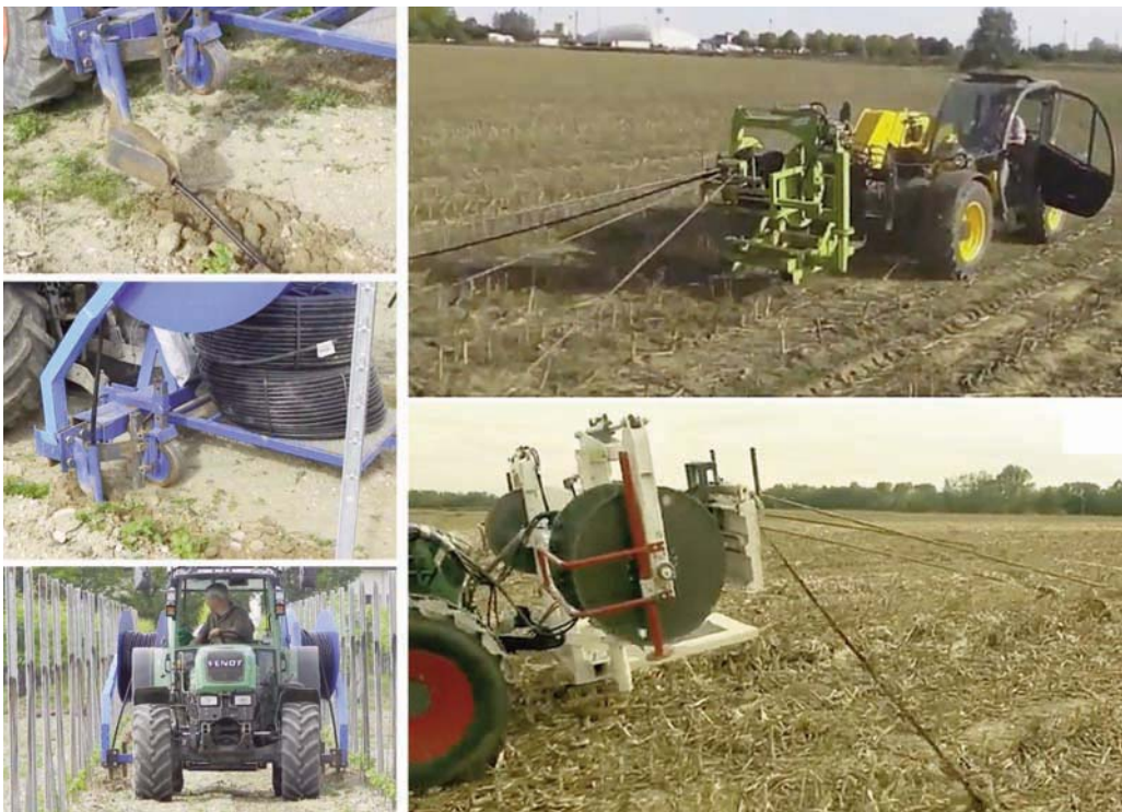
Sia per la posa delle ali gocciolanti (con o senza interrimento) che per il loro recupero, sono disponibili diverse attrezzature dedicate, a differente grado di automazione. Various dedicated devices, with different degrees of automation, are available for laying drip lines (with or without burial) and for their recovery.
