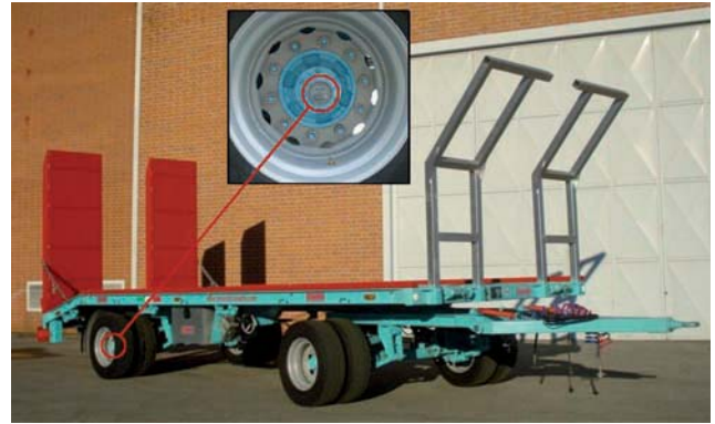
La Crosetto di Marene (CN) offre in opzione sui propri caricaballe un contachilometri meccanico inserito direttamente nel mozzo di una delle ruote del carro Crosetto of Marene (CN) offers on its bale loaders a mechanical odometer that is inserted directly into the hub of one of the wagon wheels
