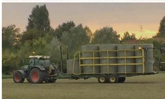
Rispetto al pianale del carro, le rotoballe possono essere caricate con l'asse principale orizzontale (sopra) o verticale (sotto) Relative to the wagon bed, the round bales can be loaded with a horizontal (top) or vertical (bottom) main axis
