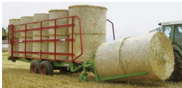
Rispetto al pianale del carro, le rotoballe possono essere caricate con l'asse principale orizzontale (sopra) o verticale (sotto) Relative to the wagon bed, the round bales can be loaded with a horizontal (top) or vertical (bottom) main axis
