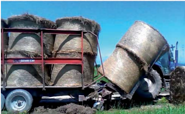
La balla può essere caricata con il carro che avanza in linea con il trattore (sopra), oppure su una traiettoria parallela (sotto). In quest'ultimo caso ci deve essere un timone disassabile The bale can be loaded with the wagon advancing in line with the tractor (above), or on a parallel trajectory (below). In the latter case, there needs to be a detachable steering shaft
