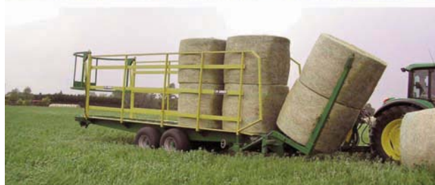
La soluzione messa a punto dalla F.lli Annovi prevede il carico di due rotoballe alla volta The solution developed by F.lli Annovi provides for the loading of two round bales at a time
