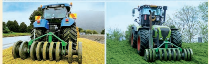
Il SilaPactor della Kelvin Cave si basa su una serie di pesanti dischi pieni, che ruotano folli su un robusto perno, per compattare l'intero fronte trattato del cumulo di insilato
