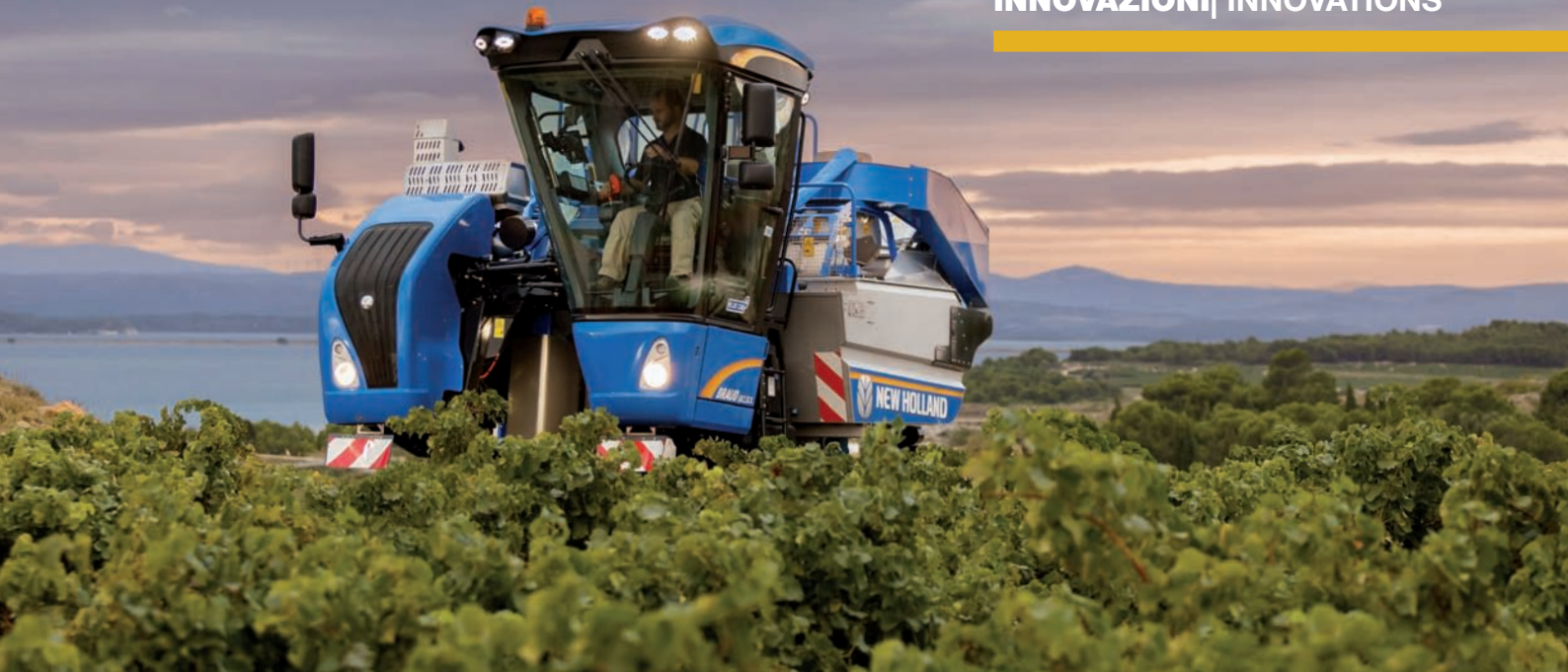
Vendemmiatrice Braud New Holland predisposta per la raccolta differenziata delle uve e il controllo georeferenziato della qualità New Holland Braud grape harvester equipped for harvest of differentiated grapes and georeferenced quality control
