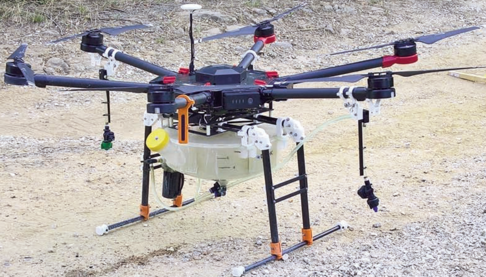
Drone per applicazioni di liquidi irrorati su vigneto (AgriSmartLab-UNIFI) Drone for applying sprayer liquid on vineyard (AgriSmartLab-UNIFI)
